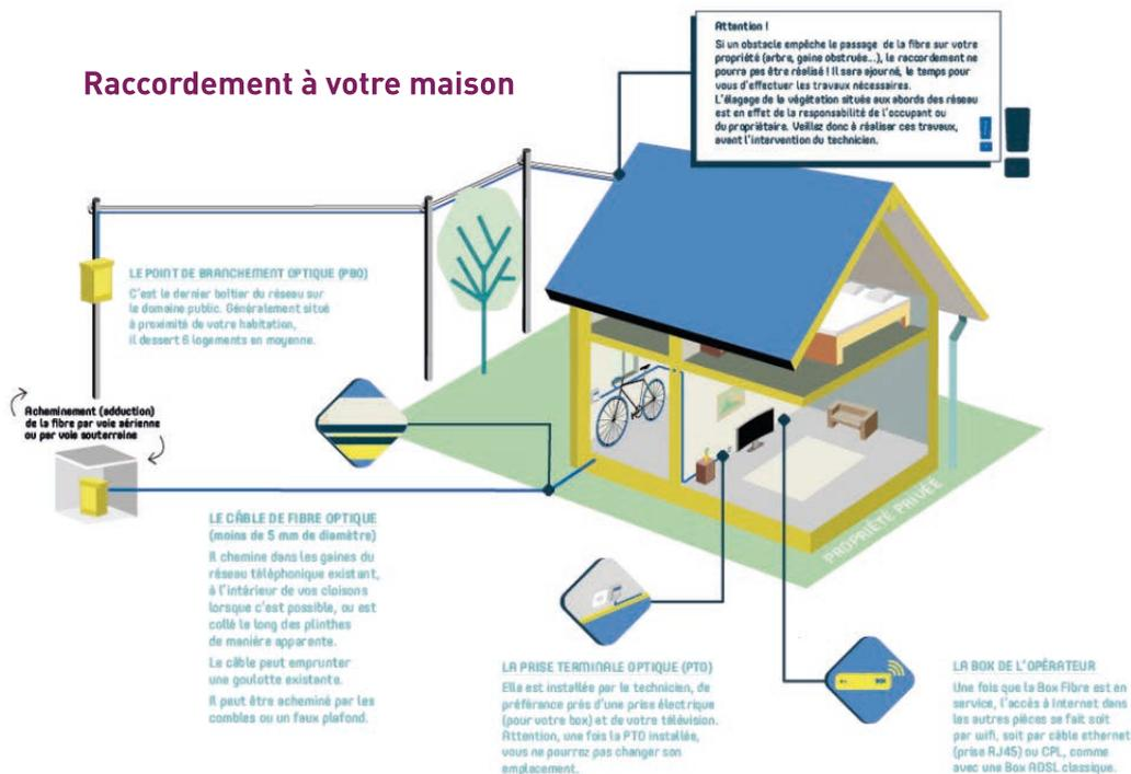
Les travaux de raccordement de votre maison consistent à **tirer un câble de fibre optique depuis le Point de Branchement Optique (PBO), le plus proche situé dans la rue, jusqu'à l'intérieur de votre maison, où une Prise Terminale Optique (PTO) sera installée.** Il s'agit d'une nouvelle prise dédiée à la fibre. Selon la configuration de votre domicile, l'intervention peut durer entre 2h et 4h.
